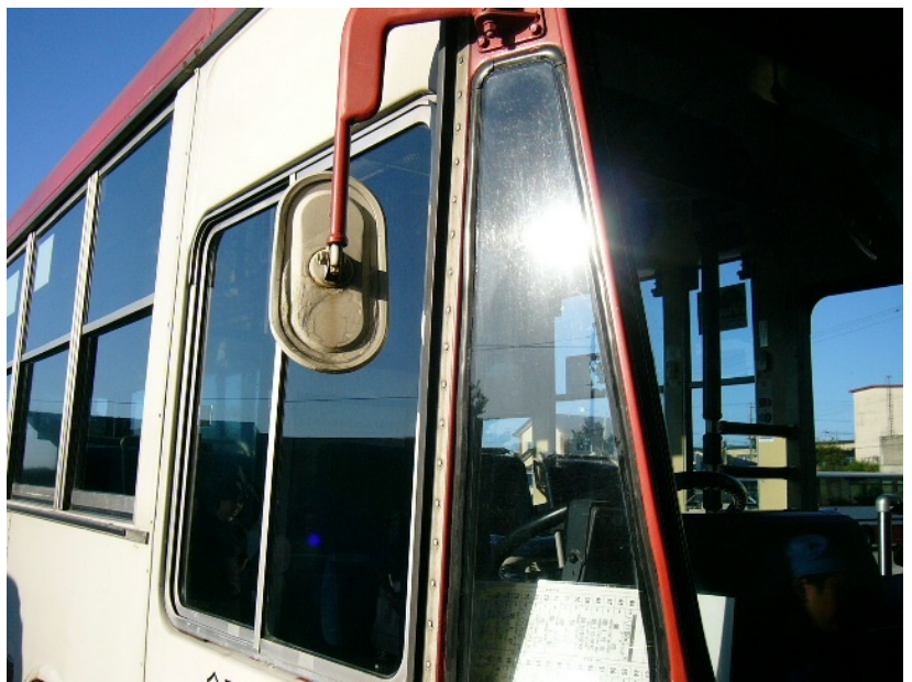
サイドガラス上部は、光が当たると加水分解の後が見られる。
